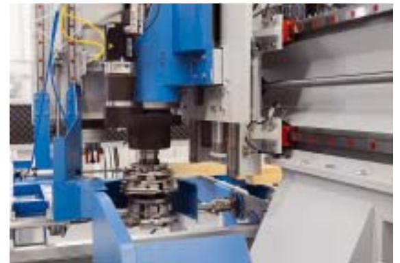
Robuste, moderne Maschinenteknik: Die 16 kW-Hauptspindel für die Querbearbeitung
