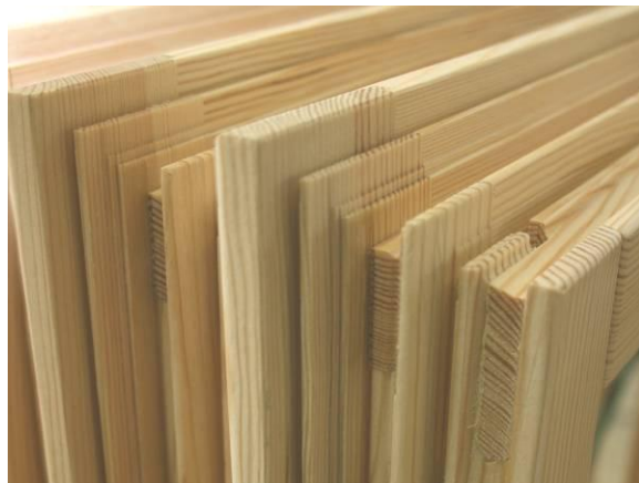
přesný rohový spoj po sklížení
