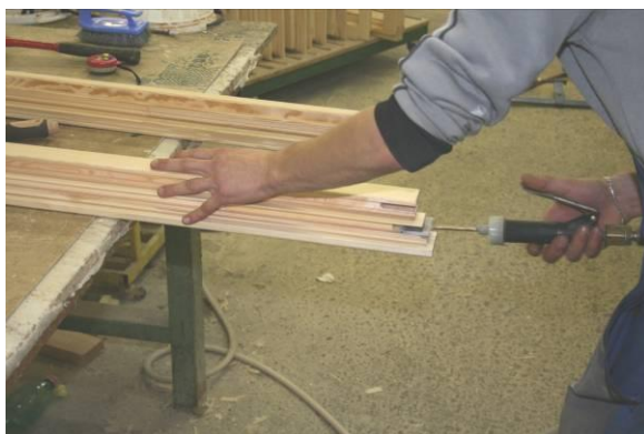
nanášení lepidla pneumotickou nanášečkou
