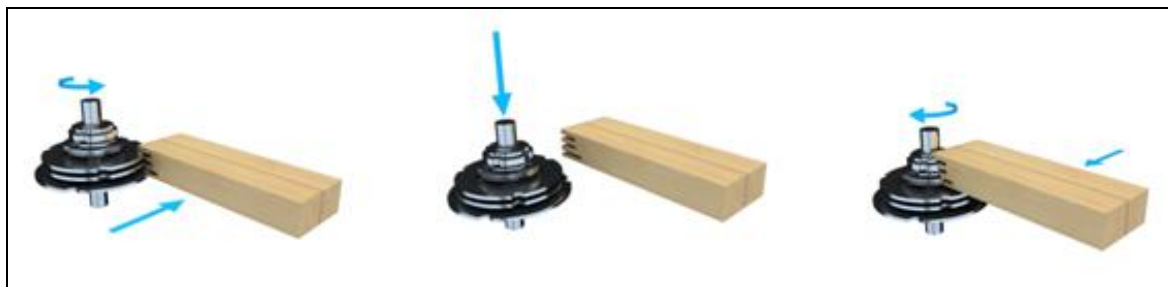
čepování jednoduchého rozporu při posuvu vpřed
