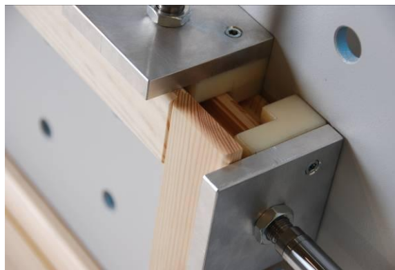
klížení v lise s opěrnou vložkou
