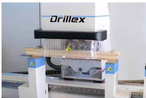
horní a zadní vrtání s upnutím dílce na pohyblivých stolicích
