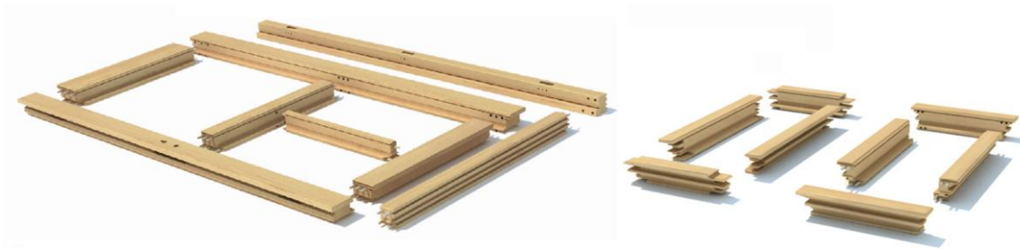
Dílcová metoda výroby okenních a dveřních komponentů spojených čepováním nebo kolíkováním
