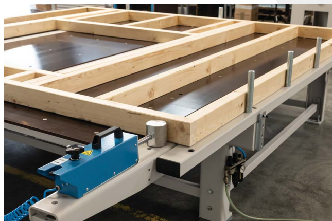
Pincettes pneumatiques avec force de serrage de 1200 N (6 bar)
