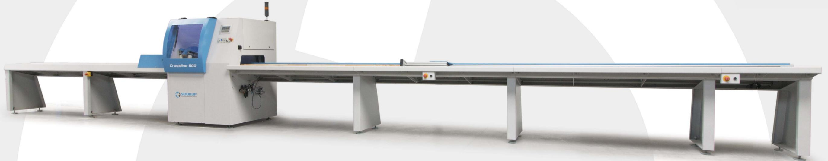
Une scie à tronçonner automatique est essentiellement constituée d'un groupe principal à lame de scie de  $\varnothing 500$  mm, d'un pousseur de chargement servocommandé électroniquement et d'une table fixe de déchargement. La machine est optimisée pour la production de fenêtres et peut être mise en œuvre dans les lignes de production équipées de convoyeurs et de manipulateurs prenant en charge la manutention des bois.
