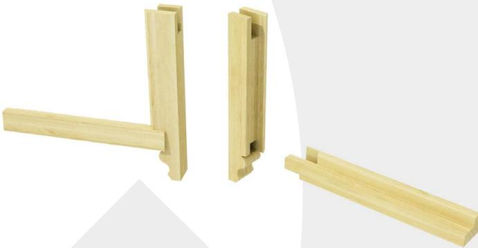
Traitement des traverses de jonction biaisées et des frises avec le détail des angles.
