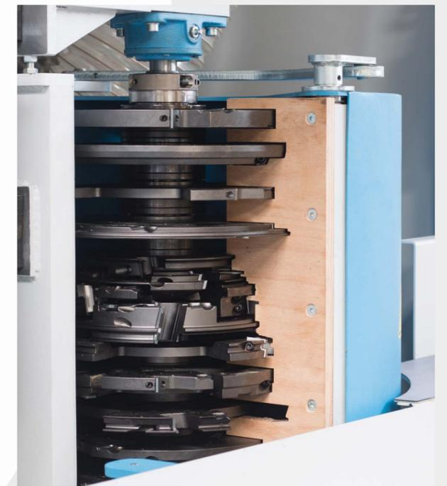
le brise-copeaux de tenonnage s'adapte parfaitement à l'empilement d'outils
