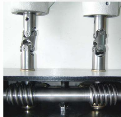
système d'alimentation de haute précision à entraînement par vis sans fin et cardans
