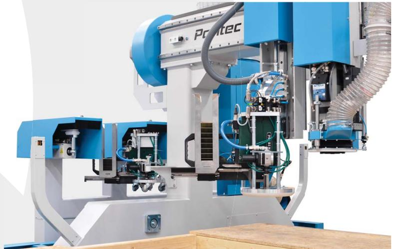
Sägeeinheit mit integrierter Absaugung
