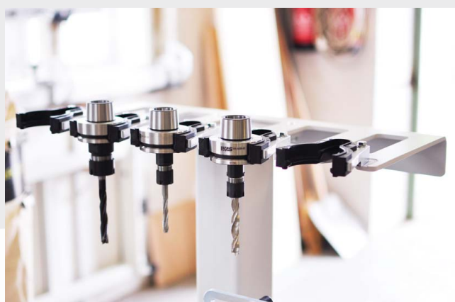
Un changeur d'outils linéaire à 5 positions
