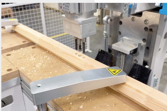
L'unité de forage vertical
