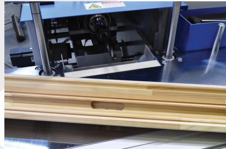
Fraisage et perçage longitudinal
