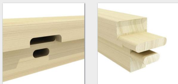
Perçage de traverses hautes et longitudinal pour tourillons
