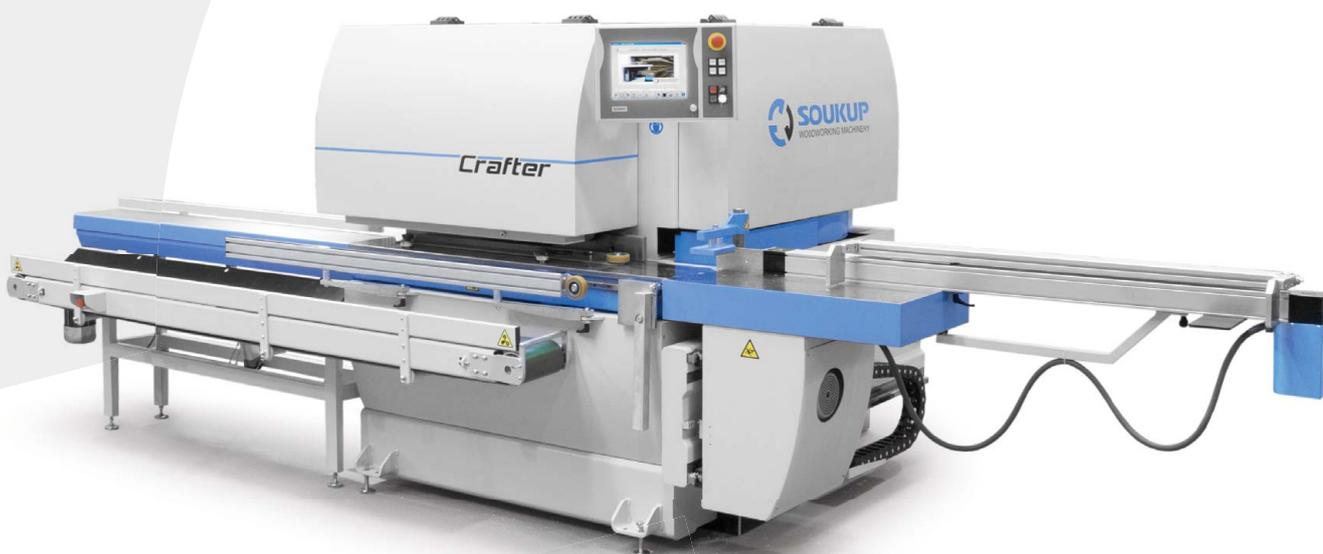
Per il funzionamento di questa macchina dalle dimensioni compatte, viene preparata una lista di produzione in ufficio, utilizzando il software WinCreator prodotto da SOUKUP, la quale sarà poi collegata direttamente alla macchina. L'operatore può quindi facilmente aprire la lista di lavoro e iniziare a lavorare. WinCreator genera una lista di lavoro di produzione per il taglio trasversale e la disposizione dei lotti prima della lavorazione, migliorando totalmente l'organizzazione dell'officina.
