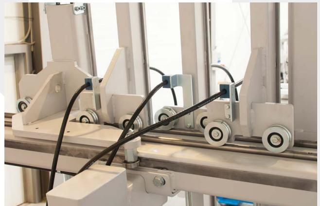
poutres de serrage sur rails coulissants pour une manipulation aisée
