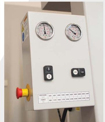
deux manomètres pour la direction verticale et horizontale
