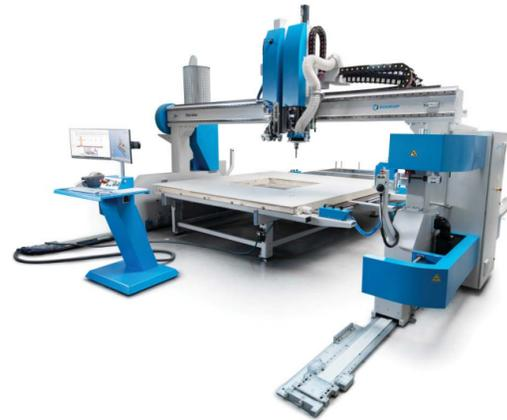
Eine komplette Produktionslinie für vorgefertigte Holzgebäude, die entsprechend den Produktionsanforderungen entwickelt wurde. Schneiden und Fräsen von Strukturelementen, Montage auf Werkbänken, Handhabung von Paneelen und komplette CNC-Brückenbearbeitung. Import von Arbeitsdaten im BTL-Format und CAM-Steuerung durch Lignocam.
